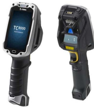
Figura 4-1- Coletor de Dados RF (fonte: 4next.com.br)
